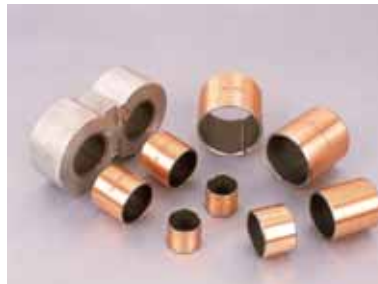
NB1T Ptfе höga PV-värden Bärighet 140N/mm 2 . Temperaturområde -195°C ~ +280°C. Max hastighet 10 m/s
