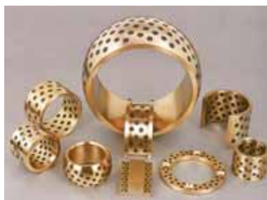
JDB-1 Mässing med fasta smörjmedel Bärighet 100N/mm 2 . Temperaturområde >300°C Max hastighet 0,4-5 m/s
