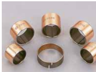
NBPK PEEK, vattentätlig Bärighet 100N/mm 2 . Temperaturområde -190°C ~ +250°C. Max hastighet 2,5 m/s
