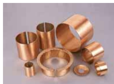
FB090 Homogen brons Bärighet 75N/mm 2 . Temperaturområde -130°C ~ +200°C. Max hastighet 2,5 m/s
