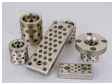
JDB-4 Gjutjärn med fasta smörjmedel Bärighet 60N/mm 2 . Temperaturområde >400°C. Max hastighet 0,5 m/s
